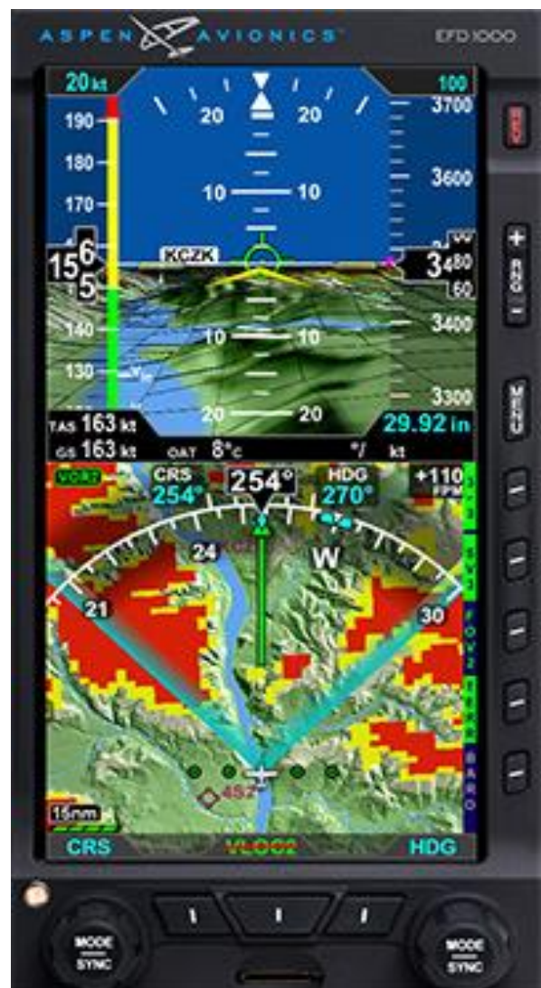
Aspen EFD 1000 PRO med terreng og SV – Svært mye informasjon på en relativt beskjeden skjermstørrelse.
